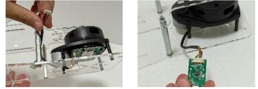
⑩ トッププレートの支柱横にある短いスリットに LIDAR 基板用ネジとワッシャーを組み合わせたものを上側から差し込みます。
